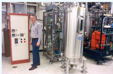
Pilotowy fermentor 300 L firmy CebTech Service Aberdeen, ND, USA
